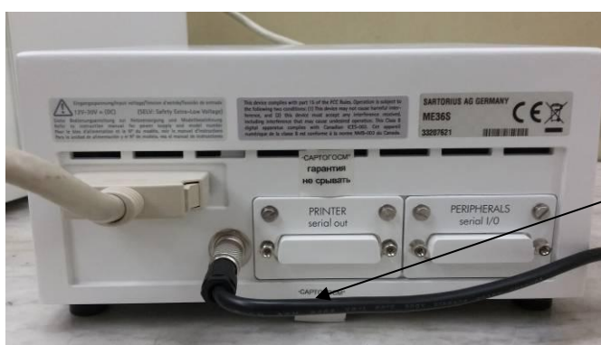
Рисунок 2 - Схема пломбирования от несанкционированного доступа
