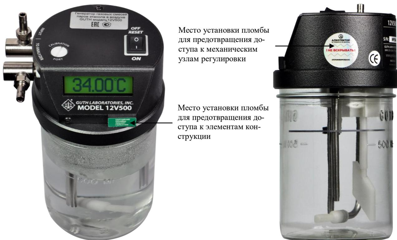
Место установки пломбы для предотвращения доступа к механическим узлам регулировки
