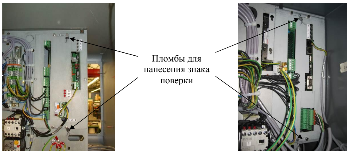
Рисунок 5 - Схема пломбирования крышки электронно-вычислительных устройств Т20 и Т30
