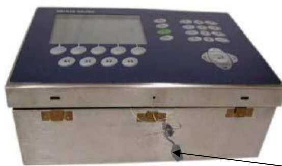
Рисунок 4 - Схема пломбировки панельного исполнения терминалов
