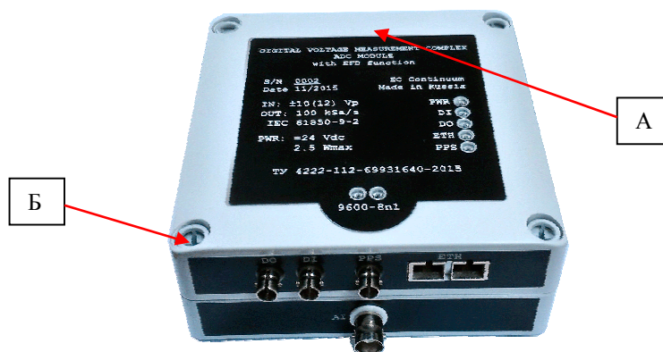
Рисунок 2 - Место пломбировки от несанкционированного доступа (Б) и обозначение места нанесения знака поверки (А)
