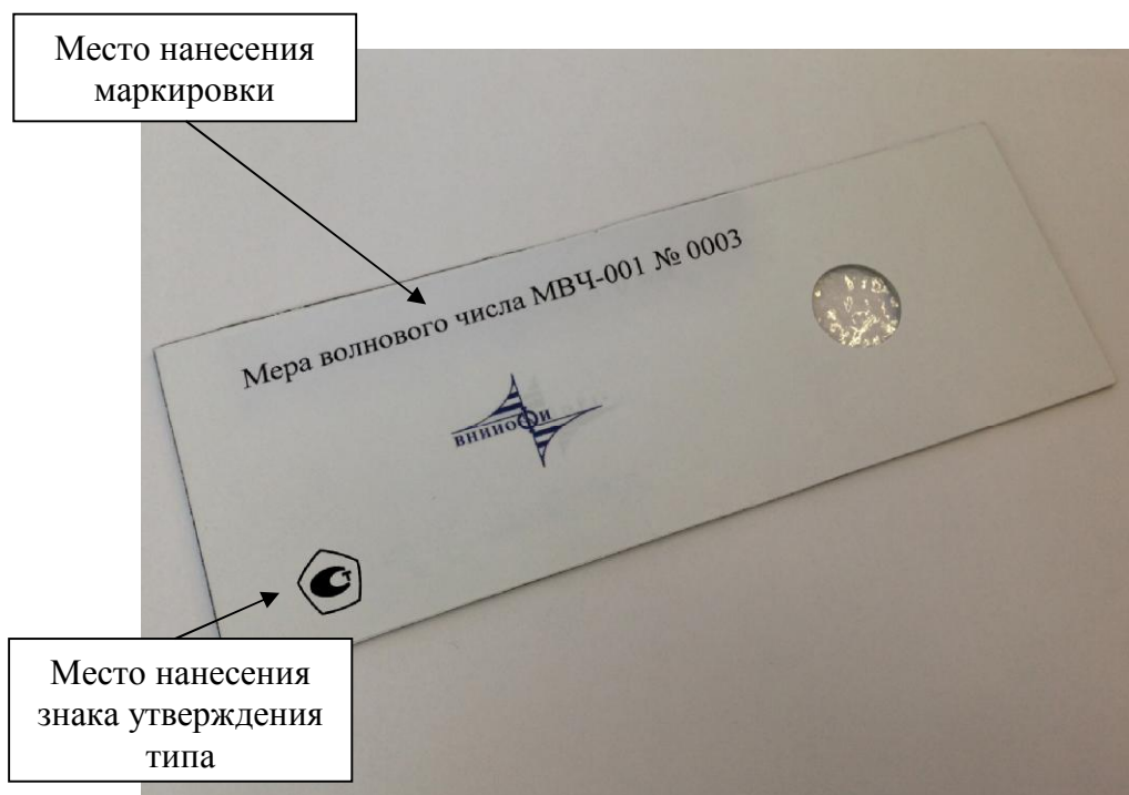
Рисунок 1 - Общий вид мер волнового числа МВЧ-001 с указанием места нанесения маркировки
