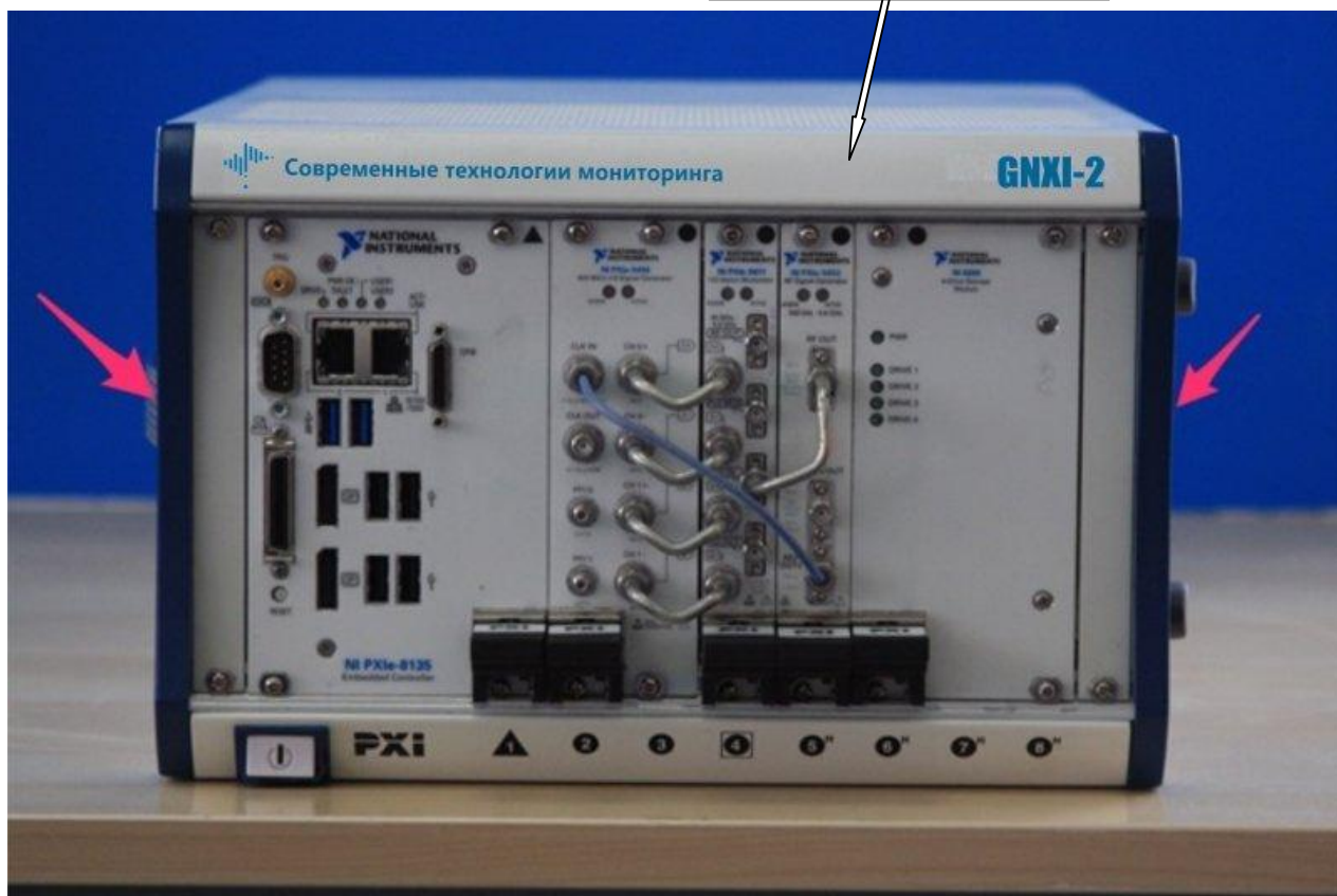
Рисунок 3 - Внешний вид имитатора GNXI-2 и места пломбировки от несанкционированного доступа и нанесения знака об утверждении типа (красные стрелки - место пломбировки)
