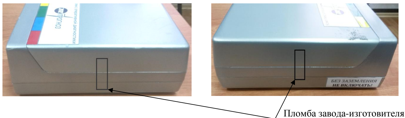
Рисунок 2 - Схема пломбирования от несанкционированного доступа
