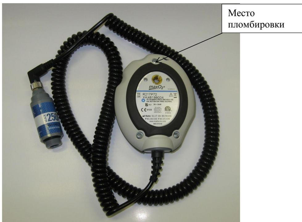
Рисунок 2 - Анализаторы кислорода MAXO<sub>2</sub>+/- схема пломбировки корпуса от несанкционированного доступа
