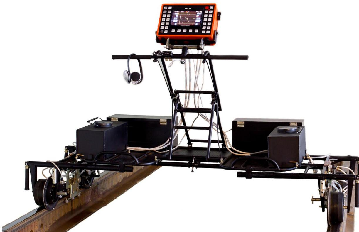
Рисунок 1 - общий вид дефектоскопов
