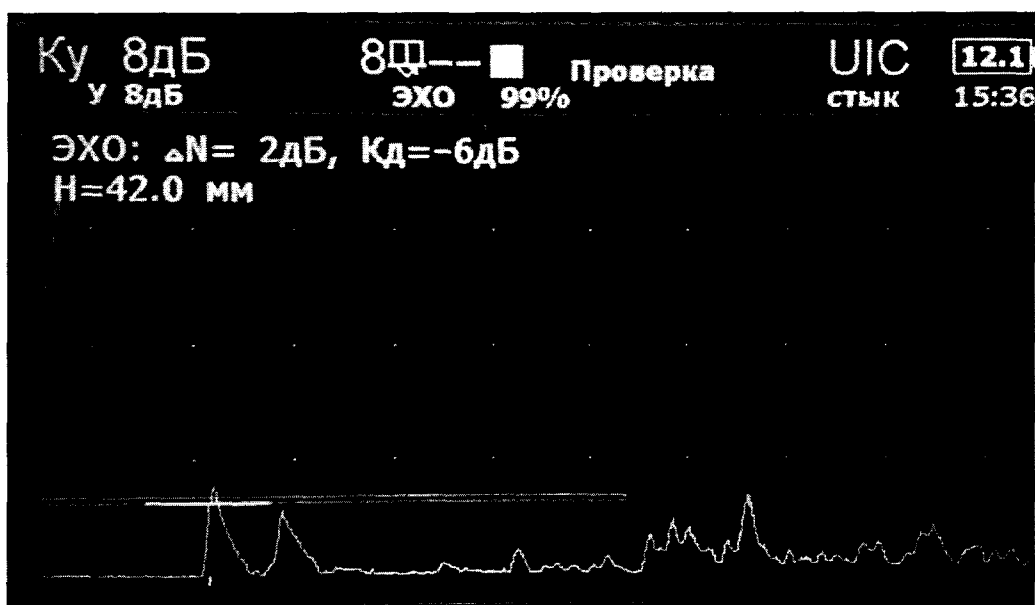
Рисунок 18. Измерение глубины залегания отражателя
