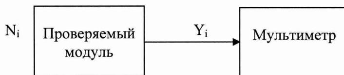
Рисунок 3 – Схема проверки модулей комплексов, реализующих линейное цифро-аналоговое преобразование силы и напряжения постоянного тока.
