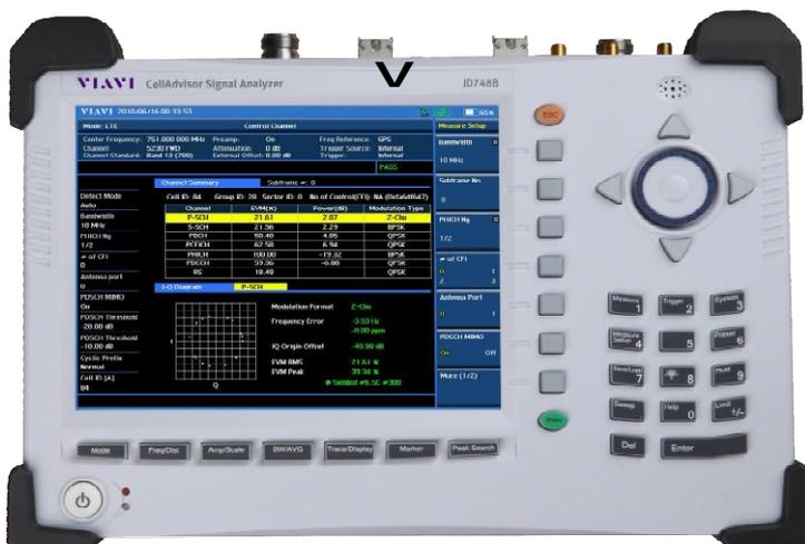
Рисунок 3 - Внешний вид анализатора JD748B
