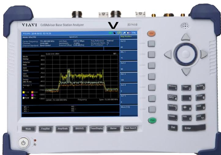
Рисунок 1 - Внешний вид анализатора JD745B
