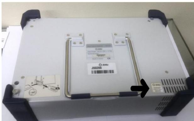
Рисунок 4 - Схема пломбирования анализаторов от несанкционированного доступа
