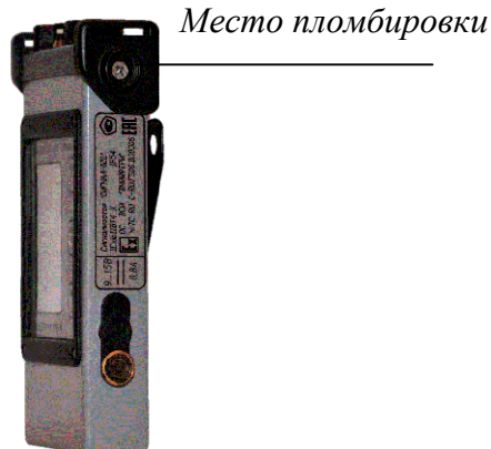
Рисунок 2 - Схема пломбировки от несанкционированного доступа
