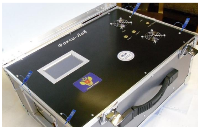
Рисунок 2 - Схема пломбировки от несанкционированного доступа
