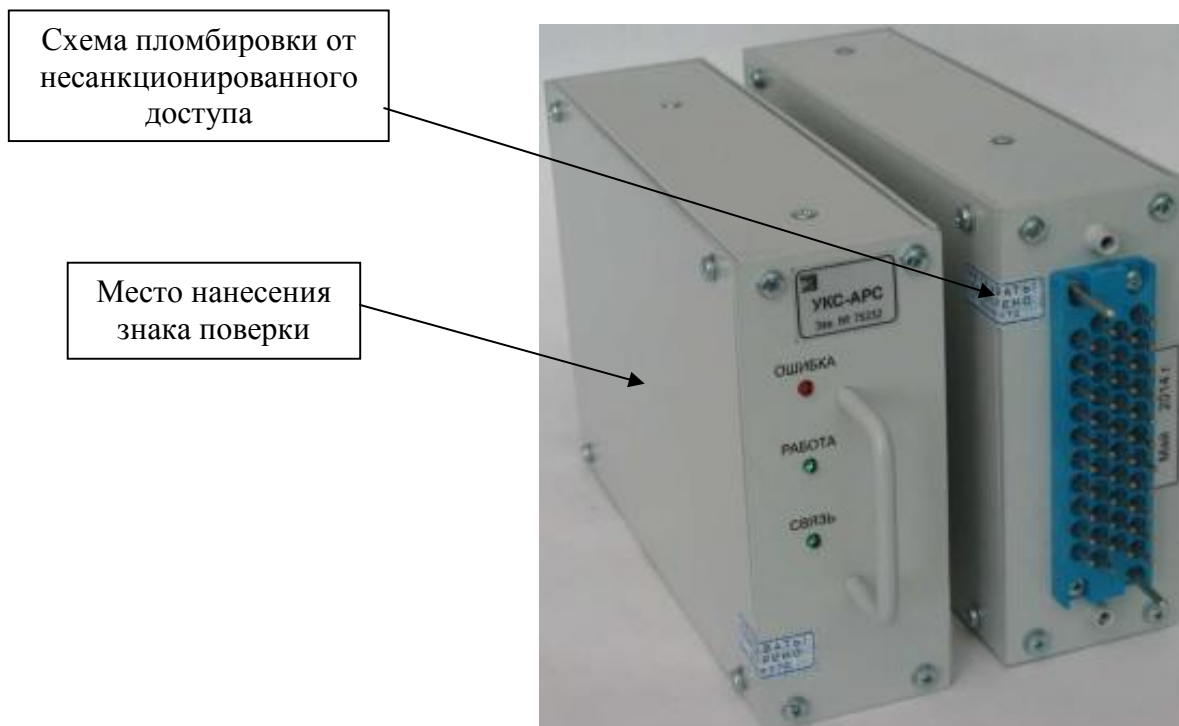
Рисунок 1 - Общий вид устройств, схема пломбировки от несанкционированного доступа, обозначение места нанесения знака поверки
