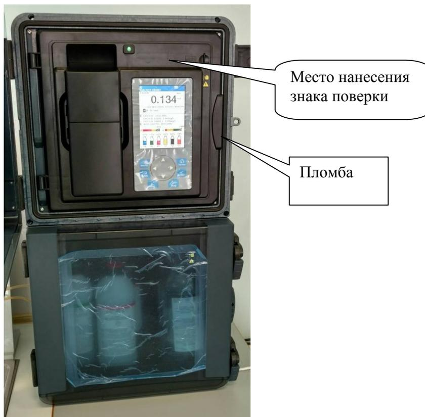
Рисунок 1 - Анализаторы серии NACH 5500 sc
