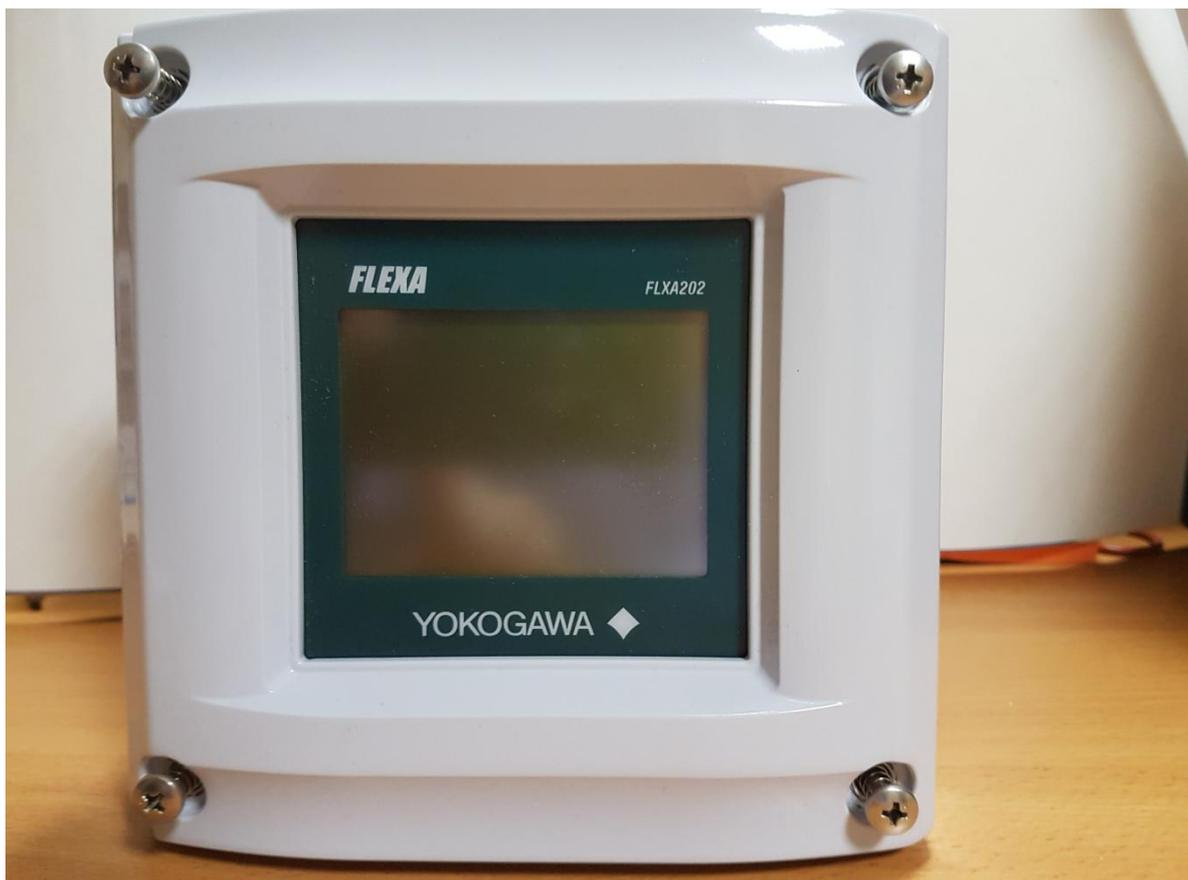
Рисунок 1 - Общий вид электронного блока анализатора жидкости FLEXA модель FLXA202
