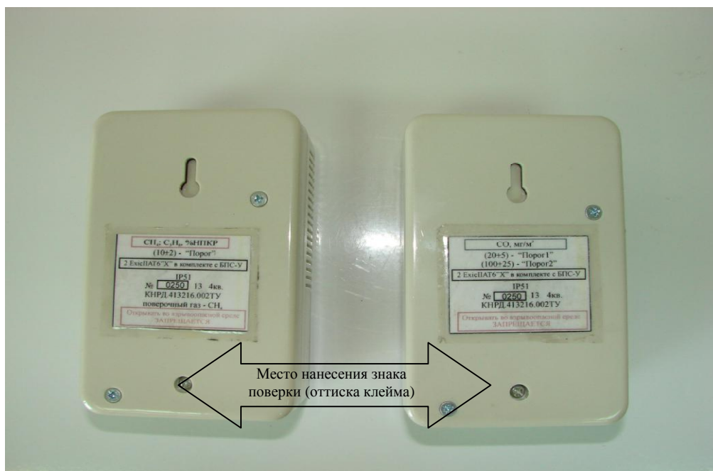
Рисунок 2 – Схема пломбировки от несанкционированного доступа, обозначение мест нанесения знака поверки
