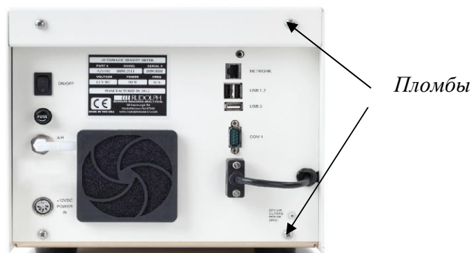
Рисунок 2 - Схема пломбировки от несанкционированного доступа.
