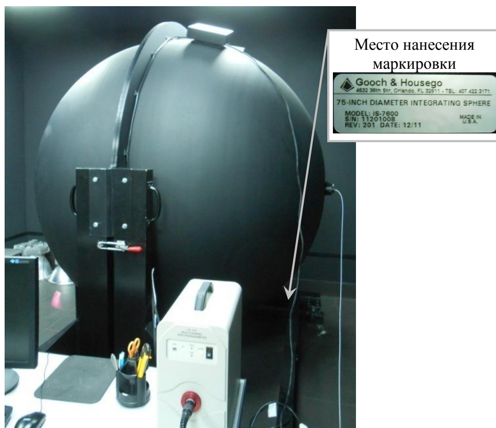
Рисунок 2 - Общий вид фотометрического шара OL IS-7600 с указанием места нанесения маркировки
