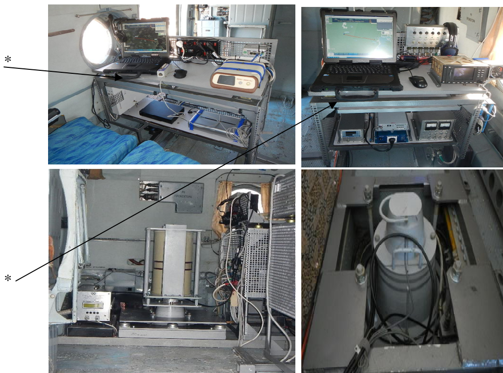
Рисунок 1 - Общий вид комплекса радиационной разведки МР-44 (* - место нанесения знака утверждения типа)
