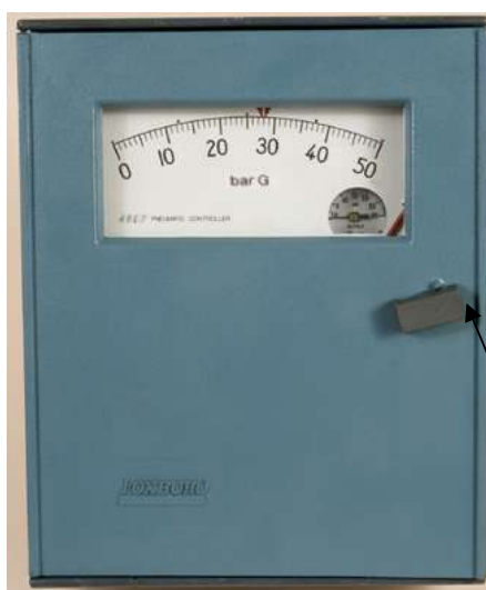
Рисунок 3 - Место пломбировки приборов контроля пневматических показывающих 43AP
