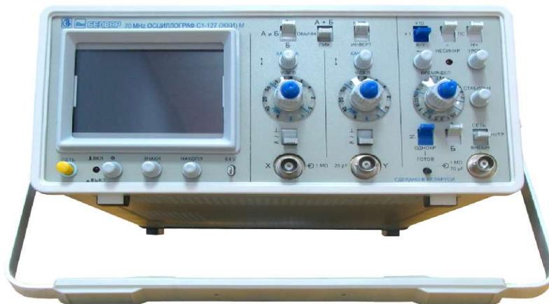
Рисунок 1 - Осциллограф С1-127 (ЖКИ) М (передняя панель)
