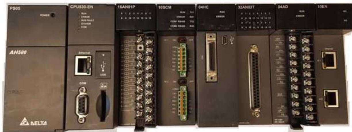
Рисунок 2 - Общий вид лицевой панели контроллеров
