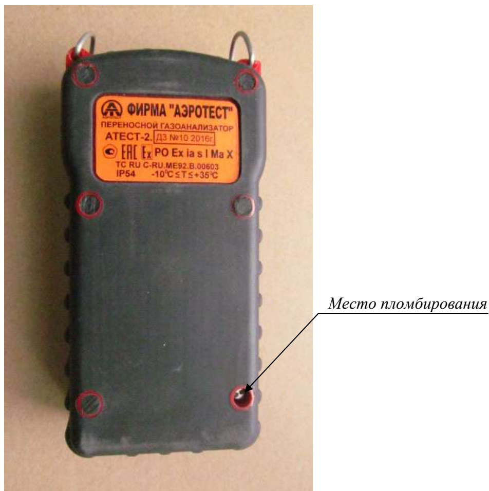
Рисунок 2 - Место пломбирования газоанализатора переносного АТЕСТ-2
