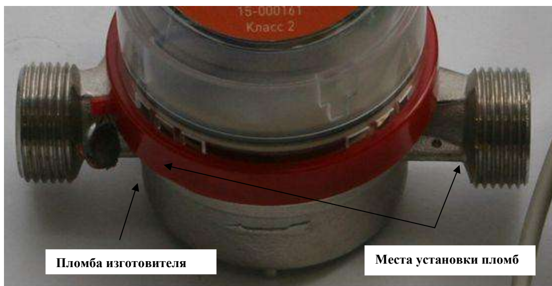
Рисунок 2 - Места пломбирования теплосчетчика HITERM модели ПУТМ-1
