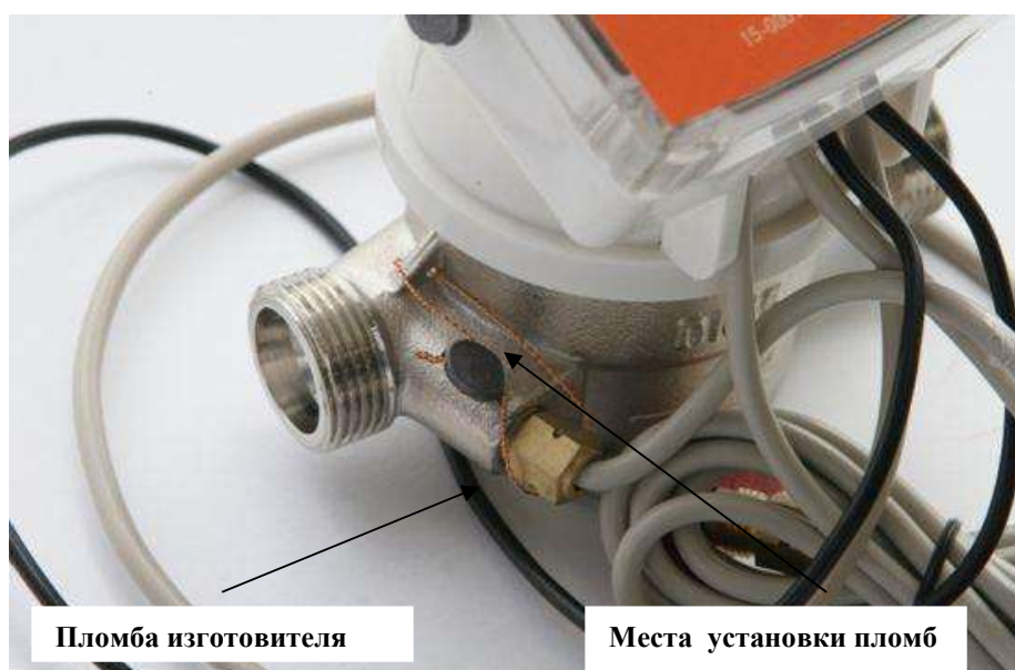
Рисунок 4 - Места пломбировки теплосчетчика HITERM модели ПУТМ-1А
