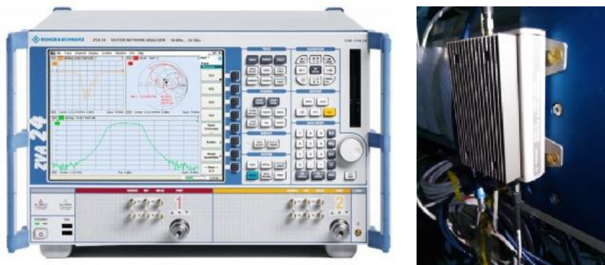
Рисунок 3 - Внешний вид векторного анализатора цепей (слева) и сверхширокополосного усилителя (справа)
