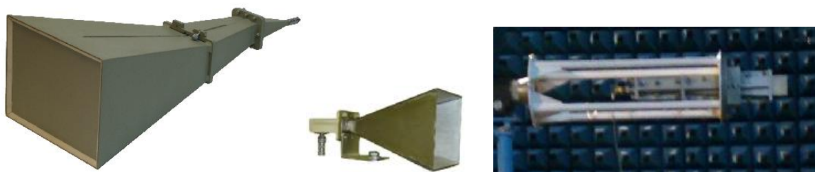
Рисунок 6 - Внешний вид комплекта антенн, предназначенных для измерения коэффициента усиления
