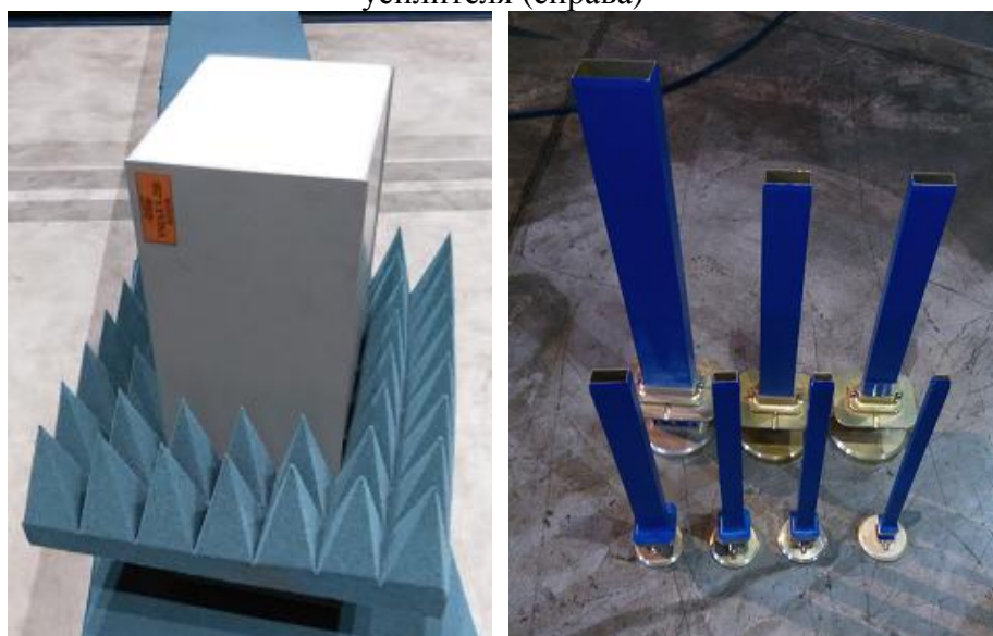
Рисунок 4 - Внешний вид антенн-зондов диапазона частот от 1 до 26,5 ГГц
