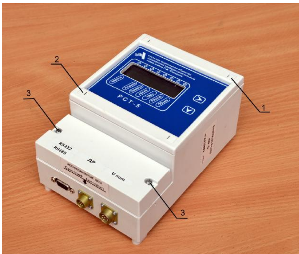
Рисунок 1 - Общий вид вычислителя и места пломбирования 1 - знак поверки; 2 - пломба завода-изготовителя; 3 - пломбирует специалист, проводящий пуско-наладочные работы
