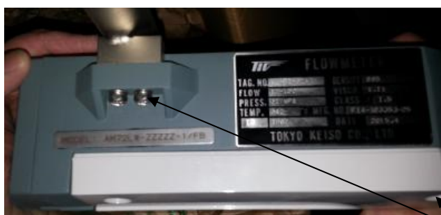
Рисунок 2 - Обозначение места пломбировки ротаметров М-901
