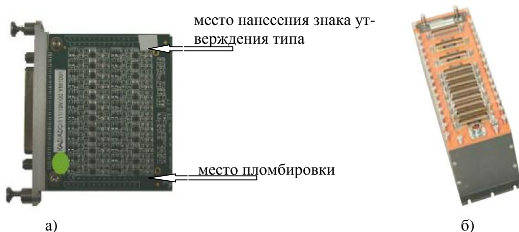
Рисунок 1 - Общий вид модуля (а) и модуля, установленного в шасси КАМ/СНС/13U (б)
