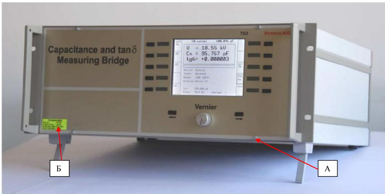
Рисунок 1 – Общий вид моста для измерения емкости и тангенса угла потерь TG-3MOD Место пломбировки от несанкционированного доступа (А) и нанесения знака поверки (Б)
