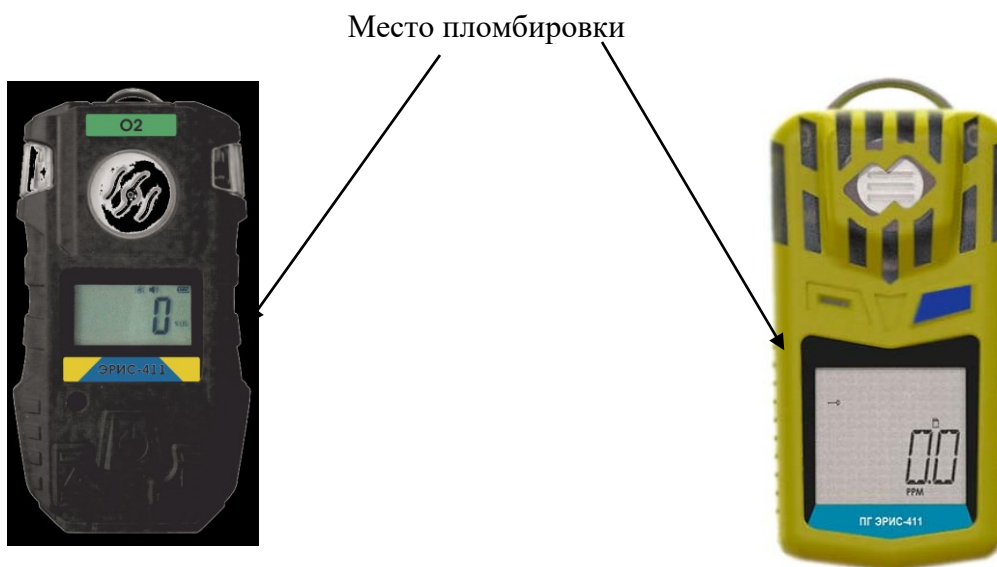
Рисунок 1 - Общий вид газоанализатора ПГ ЭРИС-411-1 и схема пломбировки от несанкционированного доступа
