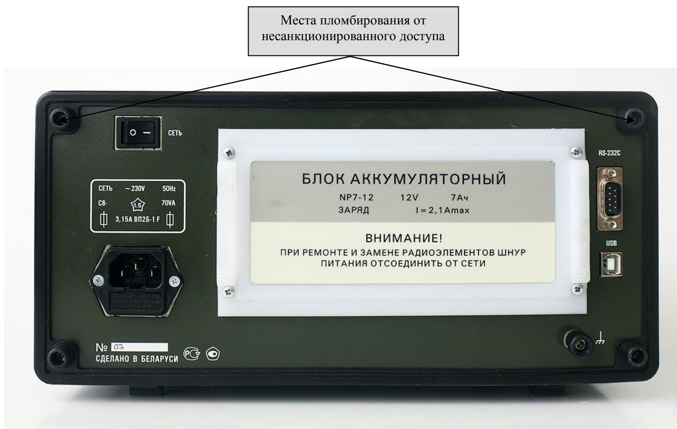
Рисунок 2 - Задняя панель осциллографа с указанием мест пломбирования
