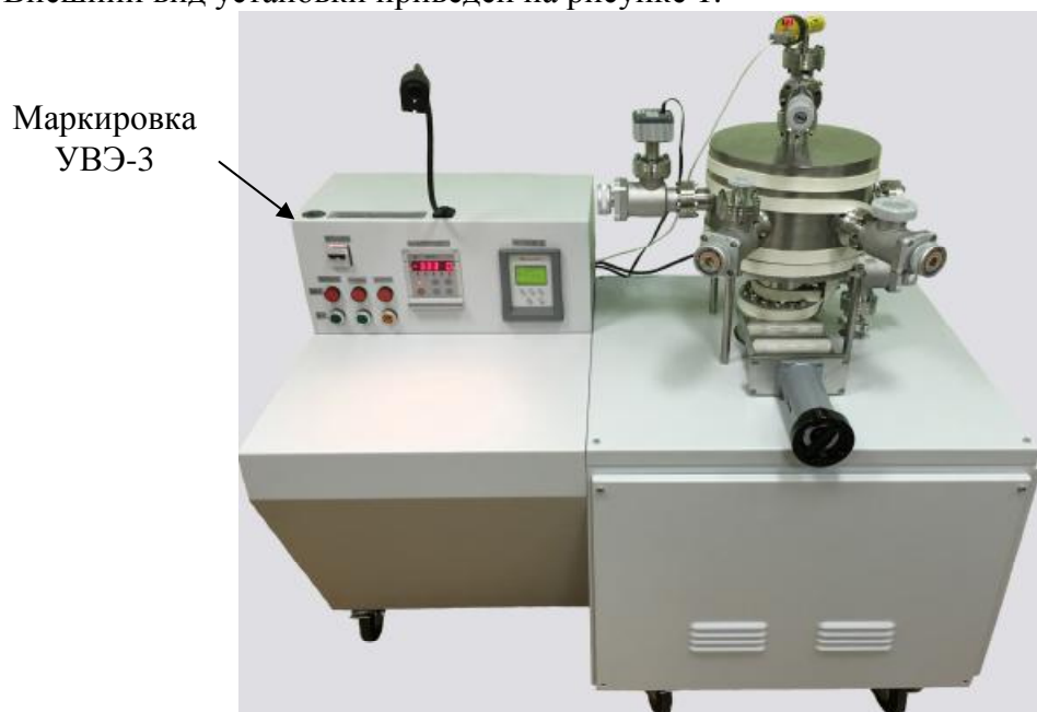
Рисунок 1 – Установка вакуумметрическая эталонная 2-го разряда УВЭ-3
