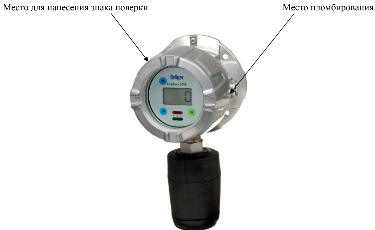
Рисунок 1 – Общий вид датчика газов электрохимического Dräger Polytron 5100
