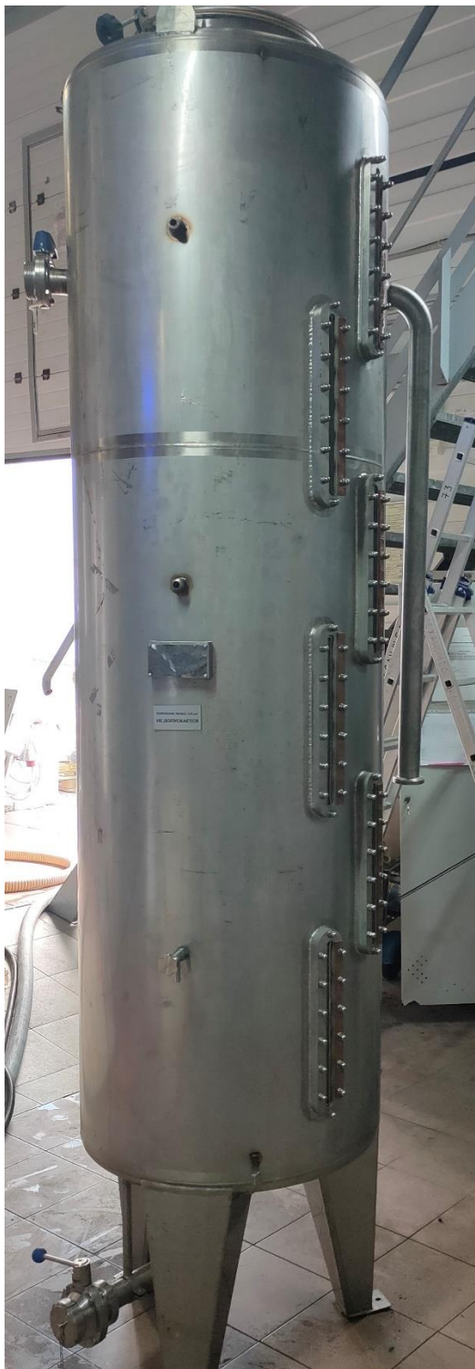
Рисунок 1 – Общий вид мерника 1 класса V=0,75 \text{ м}^3 заводской № 5166.070
