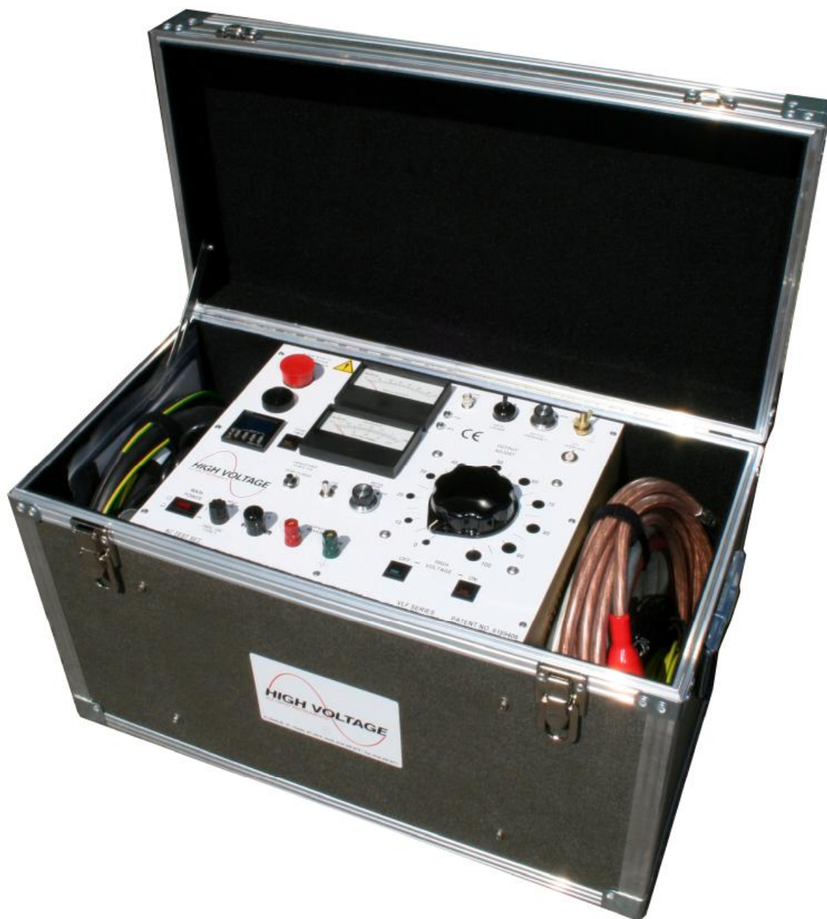
Рисунок 4 – Общий вид блока управления генераторов VLF-6022СМФ
