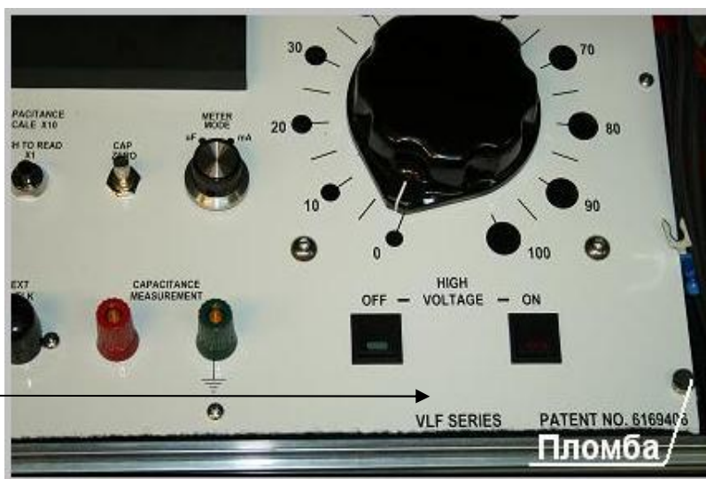
Рисунок 9 – Схема пломбировки от несанкционированного доступа, обозначение места нанесения знака поверки
