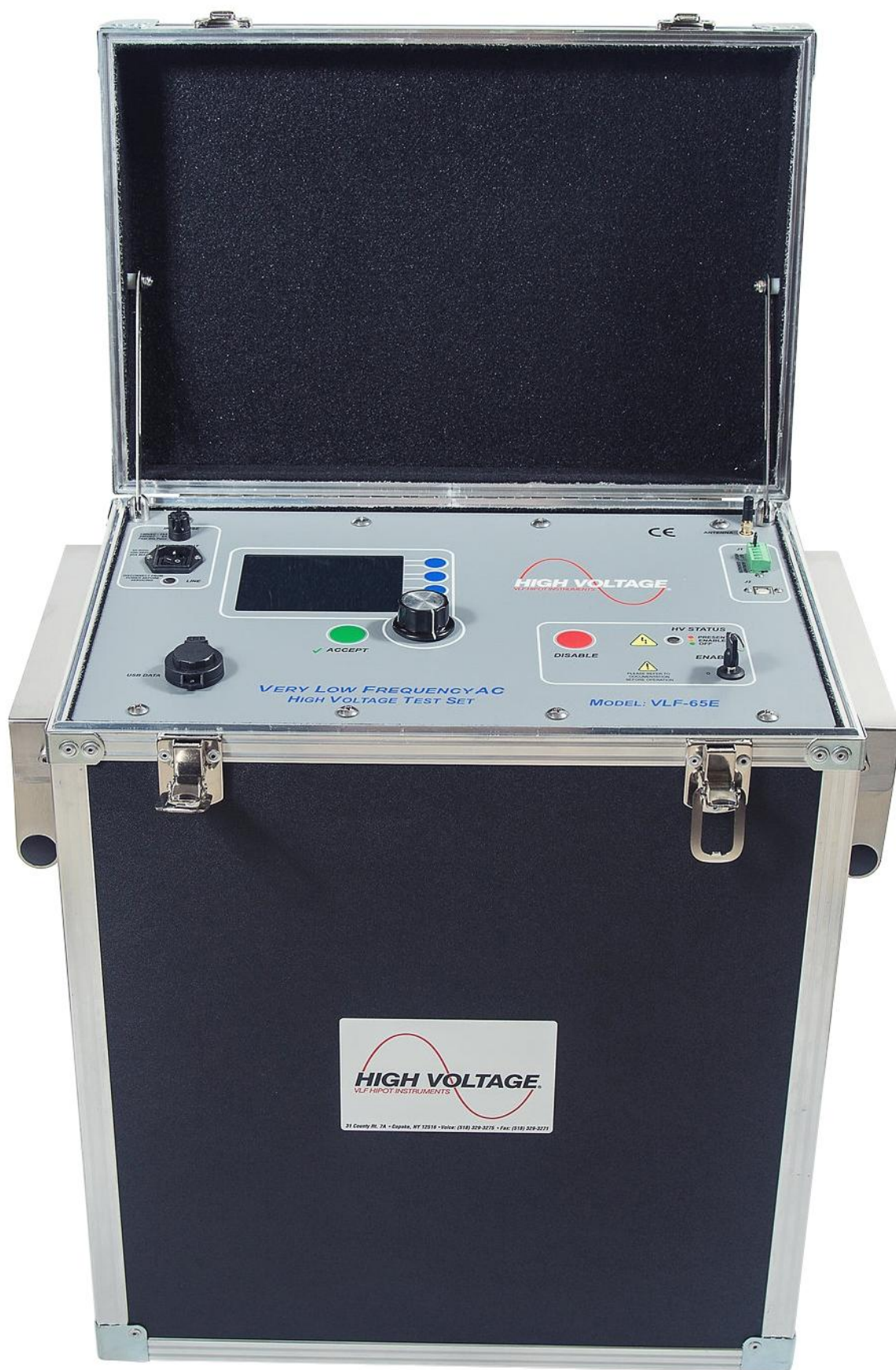
Рисунок 6 – Общий вид генераторов VLF-65E
