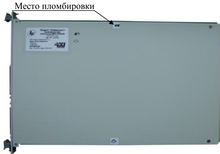
Рисунок 4 – Схема пломбировки функциональных модулей
