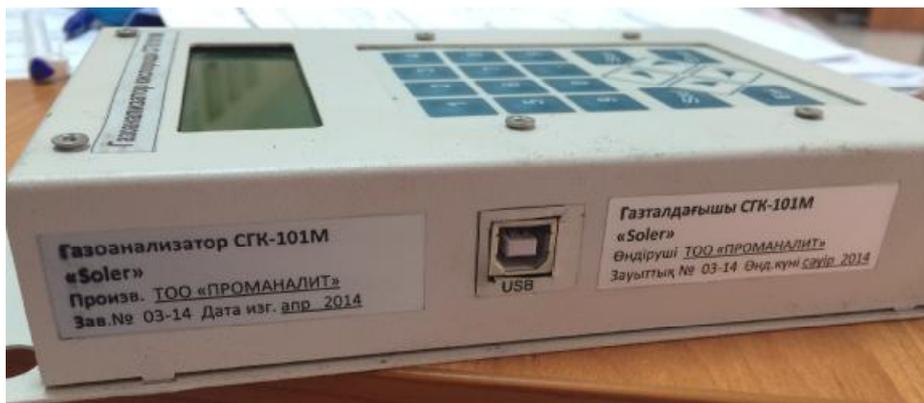
Рисунок 2 – Общий вид газоанализаторов кислорода SGK-101M «Soler».
