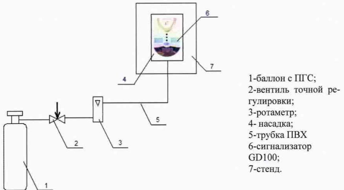
Рис. 1 - Схема подачи ПГС к сигнализатору
