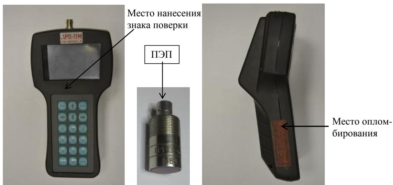
Рисунок 2 - Внешний вид измерителя АРП-11/М
