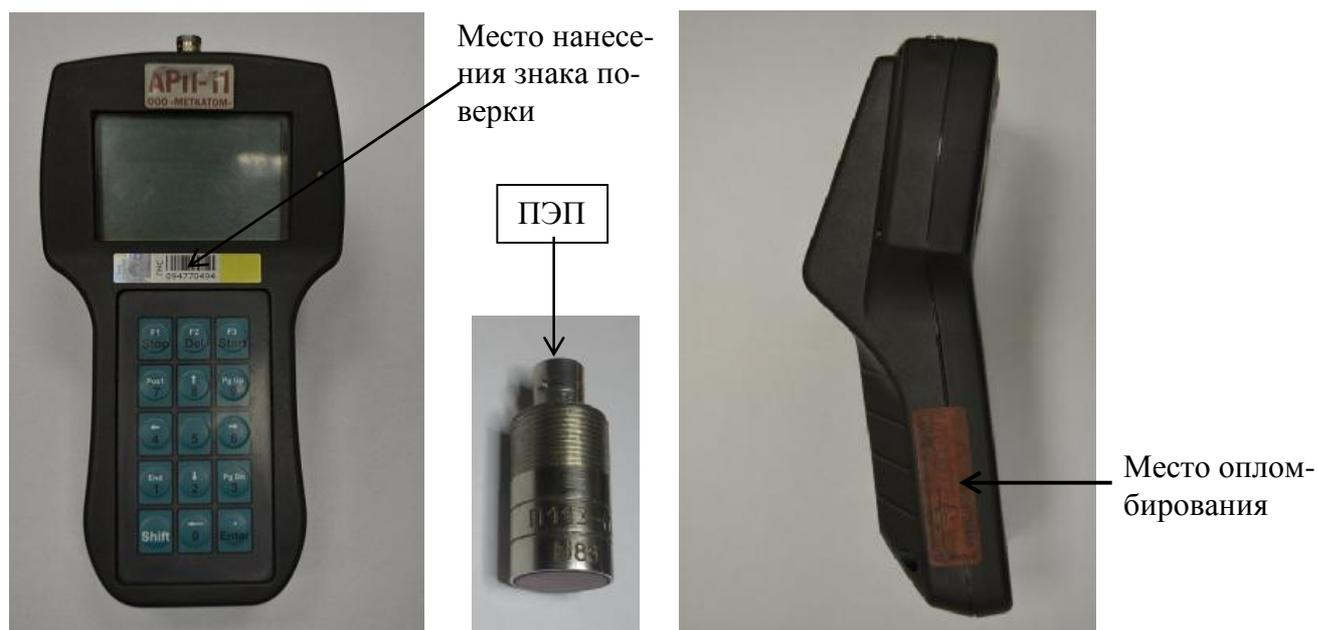
Рисунок 1 - Внешний вид измерителя АРП-11/1
