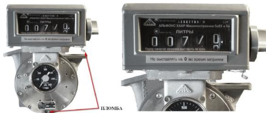
а) б) Рисунок 1 – Счетчик жидкости лопастной МКА а) Общий вид б) Механический сумматор
