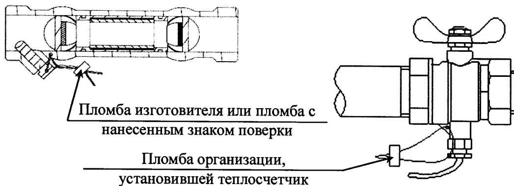
а) схема пломбировки термопреобразователя сопротивления на датчике расхода
