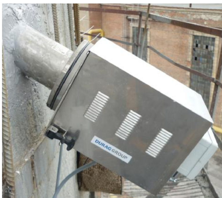
Рисунок 2 - Измеритель скорости потока D-FL-220 на месте установки (показан только один из двух блоков приемника-передатчика)
