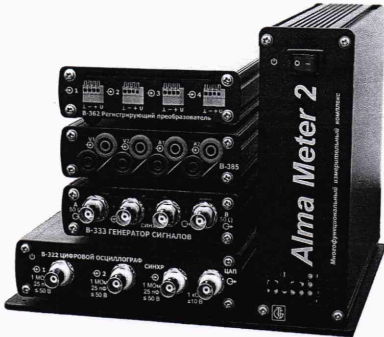
Рисунок 3 – Комплекс «Alma Meter 2», блок-секция с базовым блоком B-302
