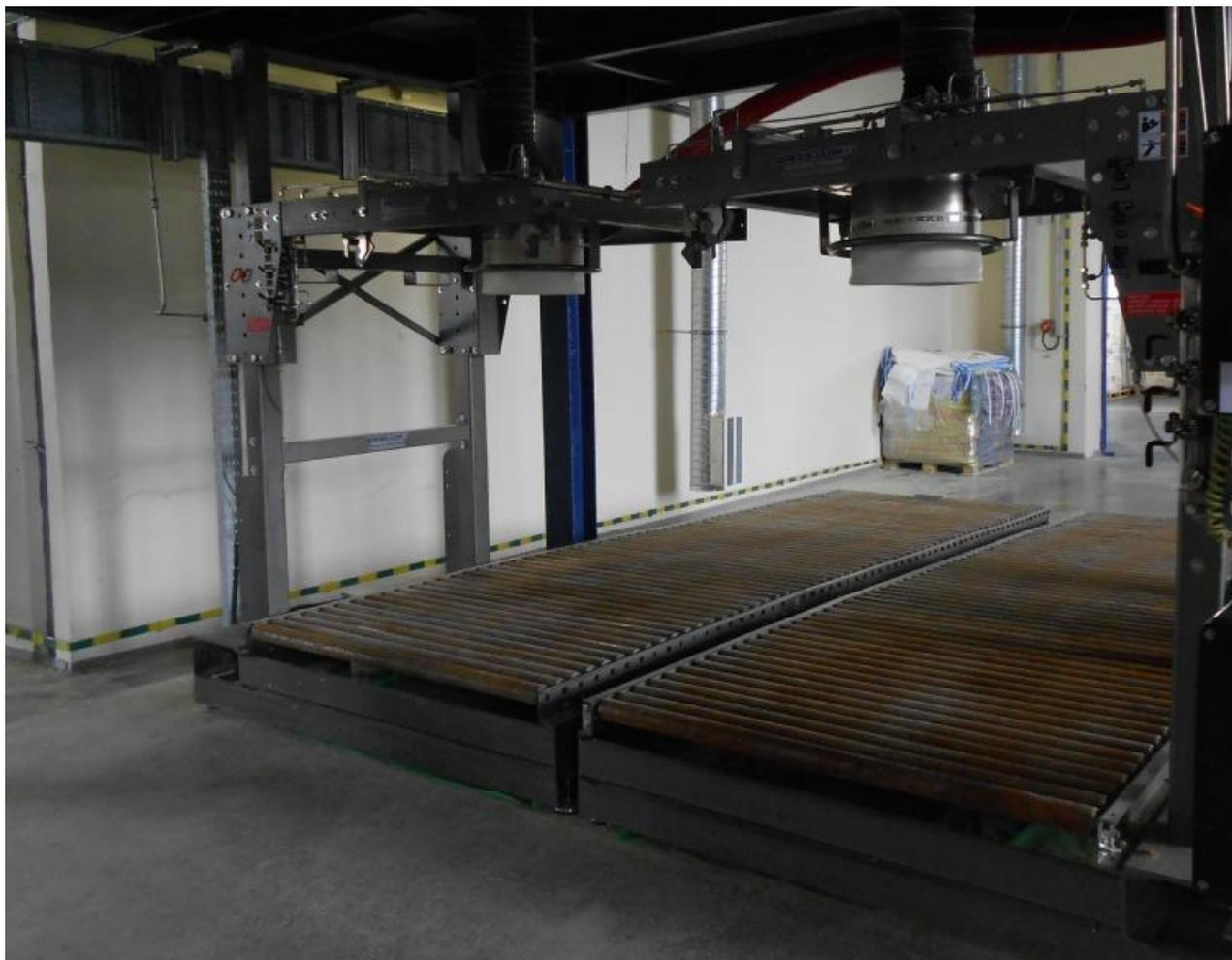
Рисунок 1 – Общий вид весов неавтоматического действия SPIROFLOW II
