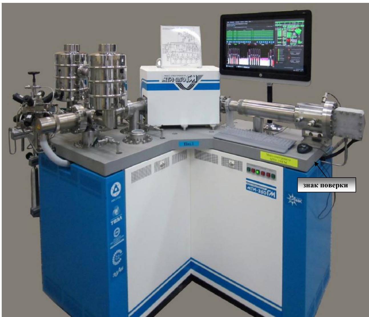
Рисунок 1 – Фото общего вида масс-спектрометра с указанием нанесения знака поверки в виде наклейки
