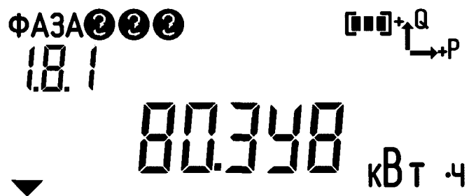
Рисунок Е.5 – Пример индикации значения потребления активной энергии по 1 тарифу
