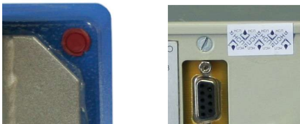
Рисунок 3 - Места пломбировка влагомера MBH-1
